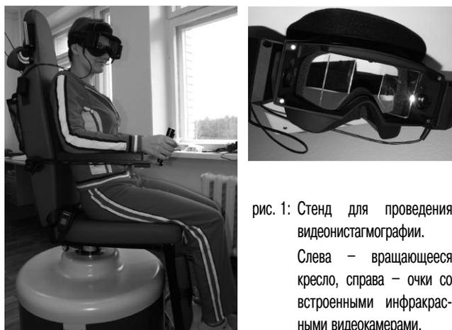
рис. 1: Стенд для проведения видеонистагмографии. Слева – вращающееся кресло, справа – очки со встроенными инфракрасными видеокамерами.
